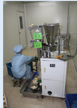
订单班学生进行 高速自动充填包装水丸
