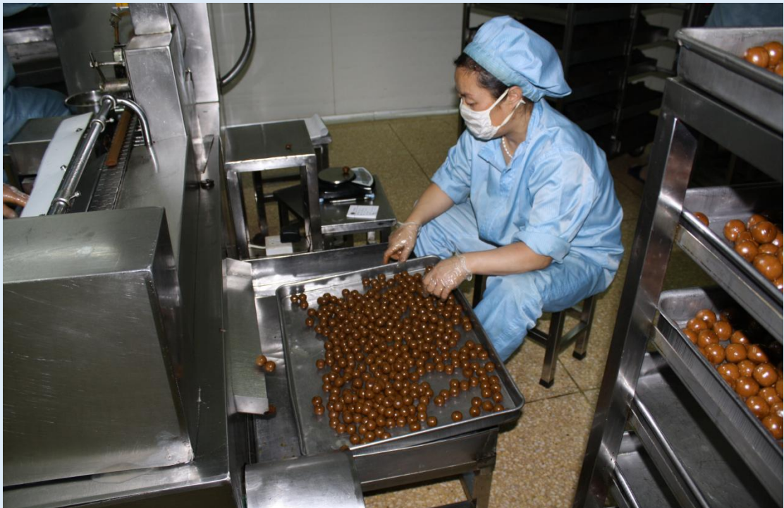
订单班学生进行检丸及重差检查
